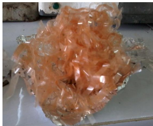
Hình 6. Dây băng đun với acetone trong 6 giờ
