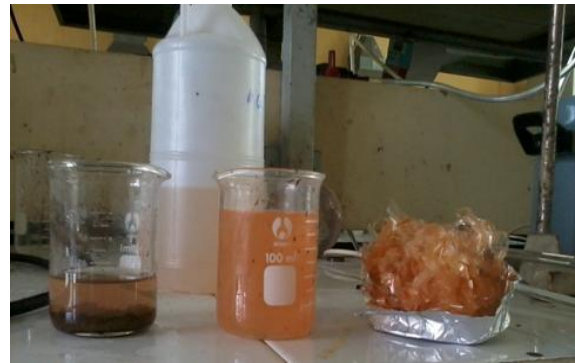
Hình 2. Thí nghiệm quá trình tách khi sử dụng dung môi acetone (10 giờ)
