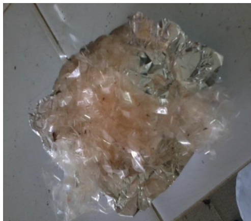
Hình 5. Dây băng đun với acetone trong 4 giờ
