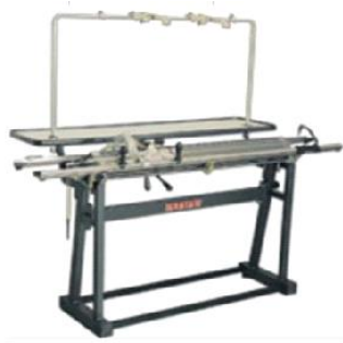
Hình 1. Máy đan len thủ công phẳng hiện đang được dùng trong sản xuất công nghiệp ở các doanh nghiệp vừa và nhỏ [3].
