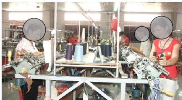
Hình 1. Máy đan len thủ công phẳng hiện đang được dùng trong sản xuất công nghiệp ở các doanh nghiệp vừa và nhỏ [3].
