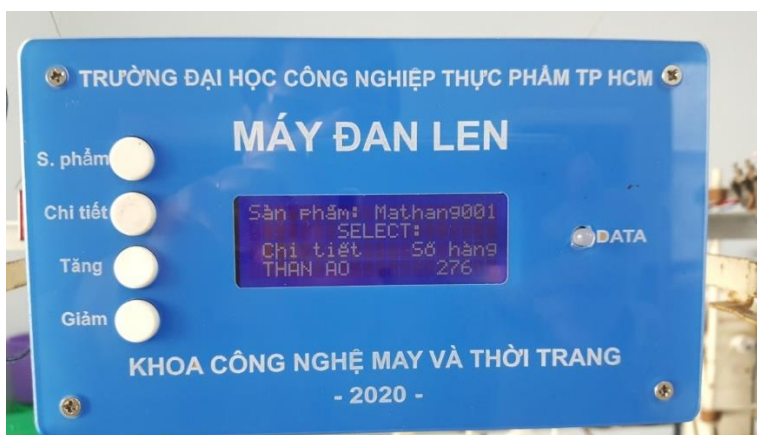
Hình 6. Bảng kế hoạch đan điện tử lắp trên máy đan
