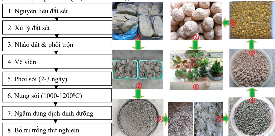
Hình 1: Quy trình sản xuất sỏi nhẹ keramzit
