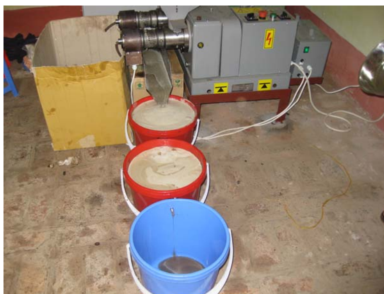
Hình 4. Quá trình lọc dầu sơ bộ bằng phương pháp lọc lắng
