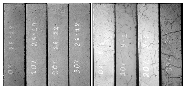
(c) Sau khi nung ở 450°C (d) Sau khi nung ở 750°C
