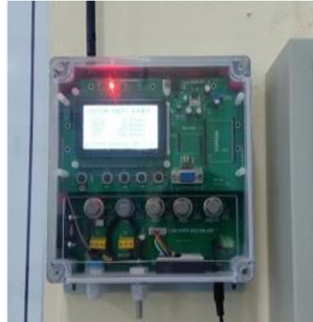
Hình 6. Thử nghiệm thiết bị đo AQI
