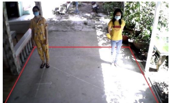
Hình 7. Lựa chọn 4 điểm để hình thành khung chuyển đổi với kích thước hình ảnh 1280x720 px
