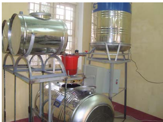
Hình 5. Hệ thống pha chế và cung cấp dung dịch tự động sử dụng trong sản xuất rau tại các nhà lưới có mái che
