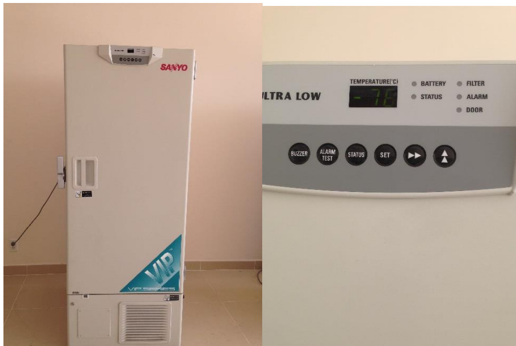
Hình 2. Tủ lạnh chuyên dụng dùng lưu trữ mẫu ở nhiệt độ âm 80°C
