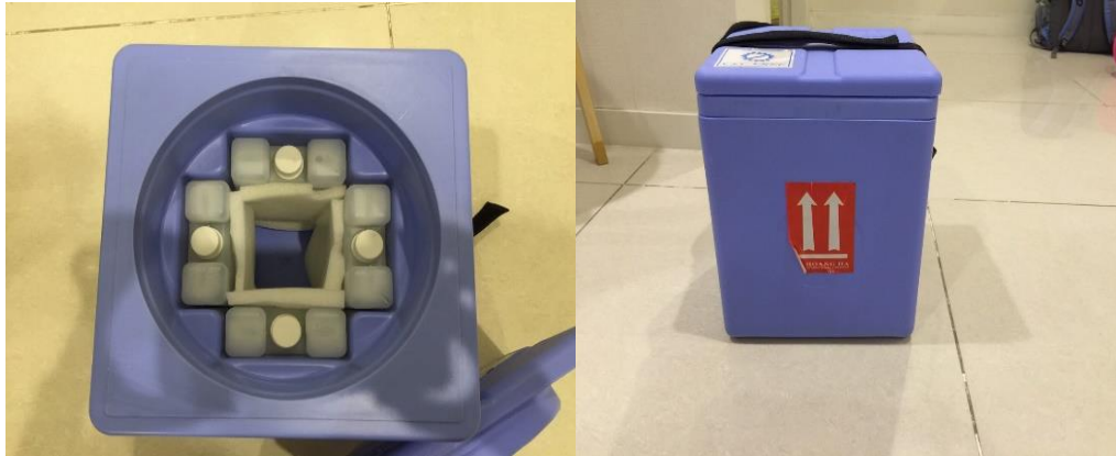
Hình 1. Bình giữ lạnh dùng cho vận chuyển mẫu huyết thanh
