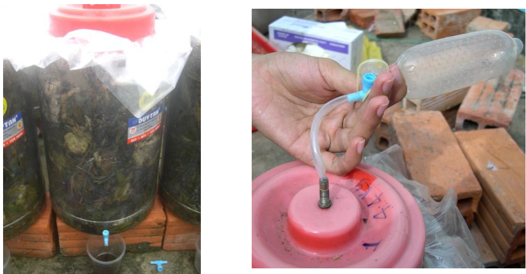
Hình 1: Mô hình thùng xử lý rác thải hữu cơ có dung tích 10-L với lỗ thoát nước rỉ rác lấy khí từ bình lên men 10-L
